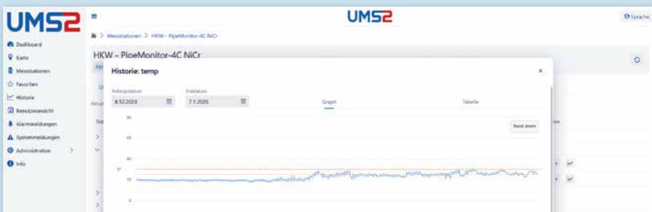
Beispiel Messwerthistorie mit Voralarm (Gelb) und Alarmgrenze (Rot).
