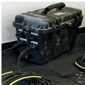
Das **PipeCase LTE** ist für die Überprüfung der vorschriftsmäßigen Installation des Überwachungssystems von Nah- und Fernwärmerohren während der Bauphase konzipiert. Mit dem **PipeCase LTE** können fehlerhafte Installationen der Überwachungsadern (Kabelbruch, falsche Anschlüsse etc.) und z. B. über Nacht entstandene Abrisse sofort erkannt und kostengünstig behoben werden. Kostenintensive, nachträgliche Erdarbeiten nach dem Verfüllen der Montagegräben entfallen.
