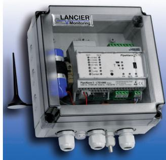
Die Geräteserie **PipeAlarm2 LTE/UMS** von LANCIER Monitoring ist die kompakte, **batteriebetriebene** Überwachungslösung für Rohrtrassen mit Überwachungsadernpaar in der Isolierschicht. Die Geräte sind leicht zu bedienen. **Stromversorgungs- und Netzwerkanalysen vor Ort sind nicht erforderlich.** Die Alarmierung im Fehlerfall erfolgt über **LTE- oder GSM-Netze**.
