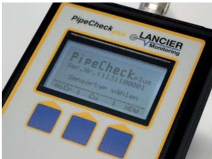
Das mobile Messgerät **PipeCheck<sub>plus</sub>** zur Überprüfung bestehender oder neu eingerichteter Messstrecken in der Fernwärmerohr-Überwachung ist klein, leicht und leistungsfähig.
